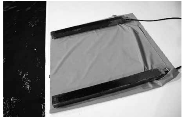
図1 体重計のバー（加重センサー）
